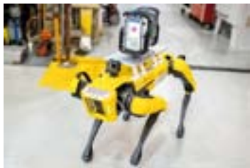
Fluffy é capaz de subir rampas e degraus, se agachar e rolar, chegando a lugares difíceis para mapear as instalações
